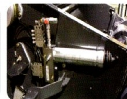
유지보수 편리 자동그리스 및 자동 체인급유 시스템
